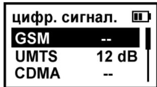
В режиме мониторинга цифровых сигналов на дисплее отображается список всех цифровых сигналов и их обнаруженные уровни. Для перемещения по списку используйте кнопки ▲ или ▼. Для мониторинга только одного выбранного сигнала нажмите кнопку [OK]. Для возврата к списку нажмите на кнопку [OK] или [C].
